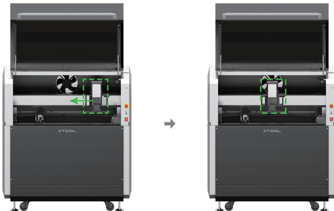
(3) Öffnen Sie die Kipphebelverriegelung.
