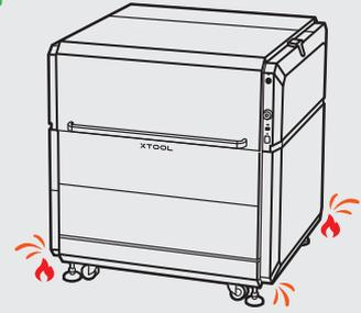
Das Schneiden von Material in der Nähe der Ränder des Arbeitsbereichs kann Funken erzeugen, die vom Boden des Geräts aufspritzen. Halten Sie brennbare Materialien, explosive Stoffe und Lösungsmittel vom Gerät fern. Der Bediener muss sich mindestens 50 cm vom Funkenbereich entfernt halten.
