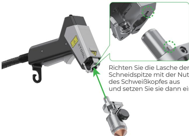
Richten Sie die Lasche der Schneidspitze mit der Nut des Schweißkopfes aus und setzen Sie sie dann ein.
