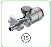
Entnehmen Sie den Schweißkopf aus dem xTool MetalFab Laserschweißgerät und tauschen Sie die Schweißspitze gegen die Schneidspitze aus.
