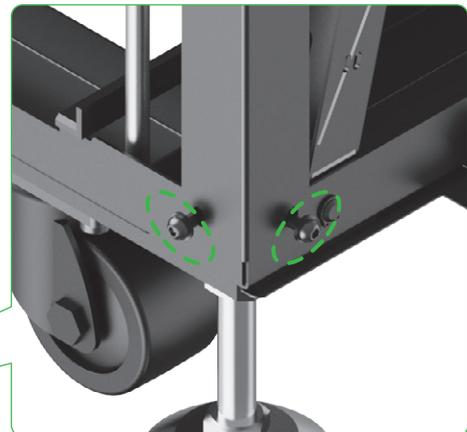
(3) Montieren Sie die restlichen drei langen Befestigungsstangen auf die gleiche Weise. Ziehen Sie anschließend alle Schrauben an den vier langen Befestigungsstangen mit dem Innensechskantschlüssel vollständig fest.
