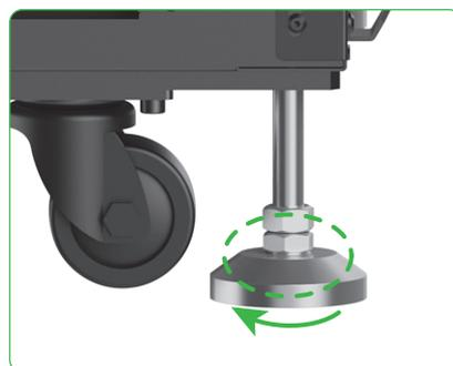
Ziehen Sie die unteren Muttern mit einem Schraubenschlüssel im Uhrzeigersinn fest.
