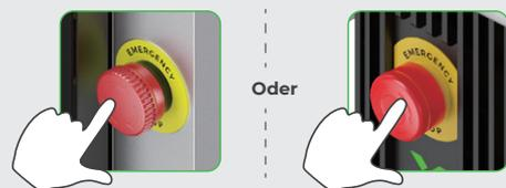
Nach der Behebung des Notfalls drehen Sie den Not-Aus-Schalter zurück, um ihn zurückzusetzen.
